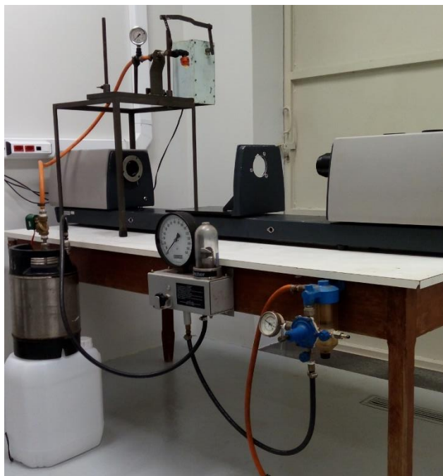
Figura 2. Aparelho medidor de diâmetro de partículas em tempo real (Mastersizer S® Malvern Instruments Co.). Jaboticabal, SP.
